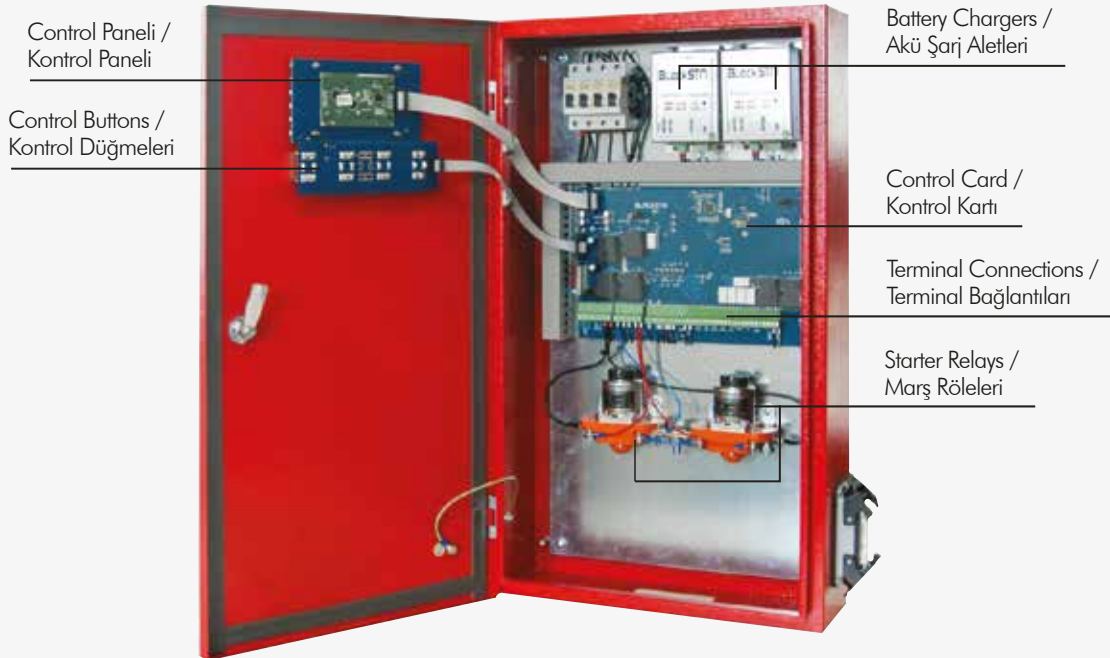
Figure 7: NFPA 20 Diesel Fire Panel Interior View Şekil 7: NFPA 20 Dizel Yangın Panosu İç Görünüm
